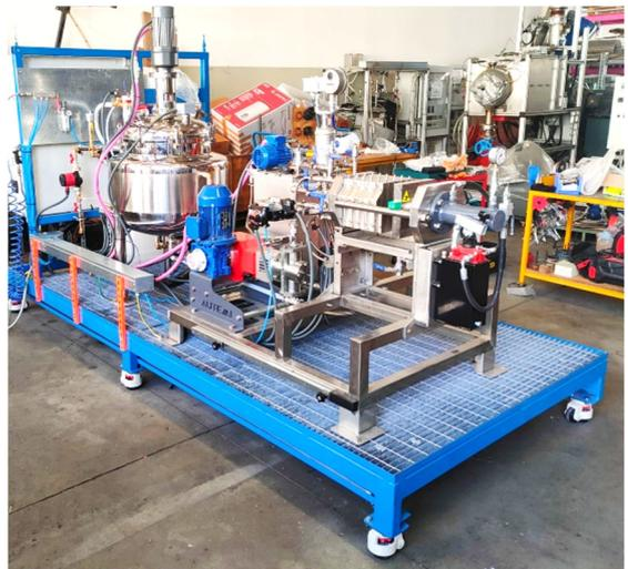
con questo processo è risultata superiore al 95% con tutti i materiali testati, inclusi fanghi di depurazione. La tecnologia è stata applicata con TRL 5 in impianto pilota da 50 lt (Foto) ed è in corso la costruzione di una unità multi-batch da 500 lt/h a TRL 7.
