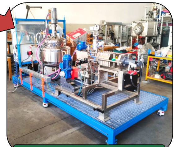
Impianto di lisciviazione Reattore da 50 L
