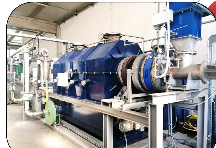
Impianto di pirolisi Fino a 50 kg/h in ingresso
