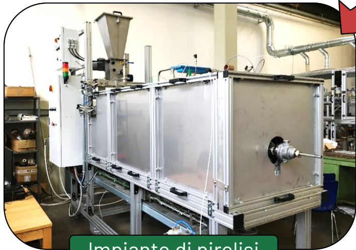
Impianto di pirolisi Fino a 5 kg/h in ingresso
